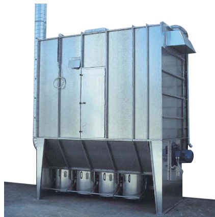
Absackfilter mit reinluftseitig integriertem Ventilator als Unterdruck-Filter.
