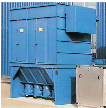
Absackfilter mit reinluftseitig integriertem Ventilator als Unterdruck-Filter.
