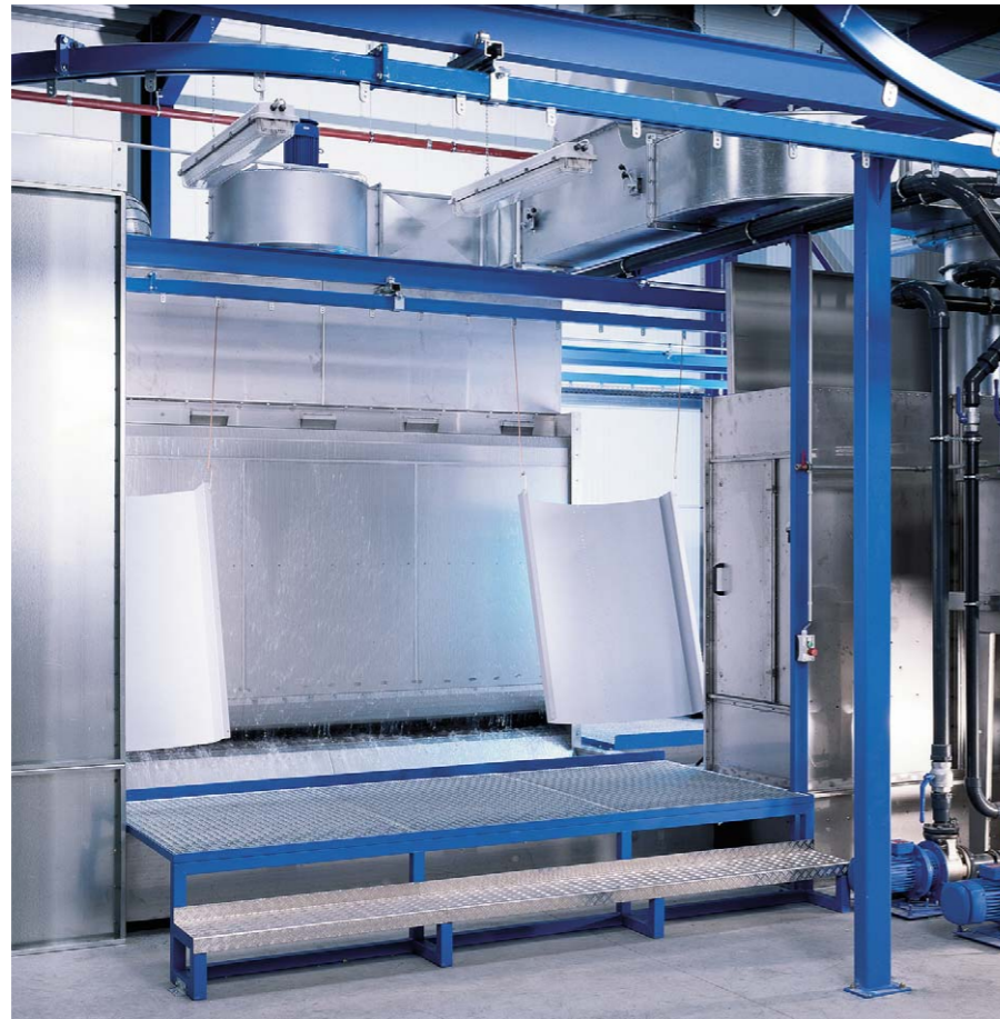
wasserberieselte Spritzwände mit Farbschlamm-Trennanlage
